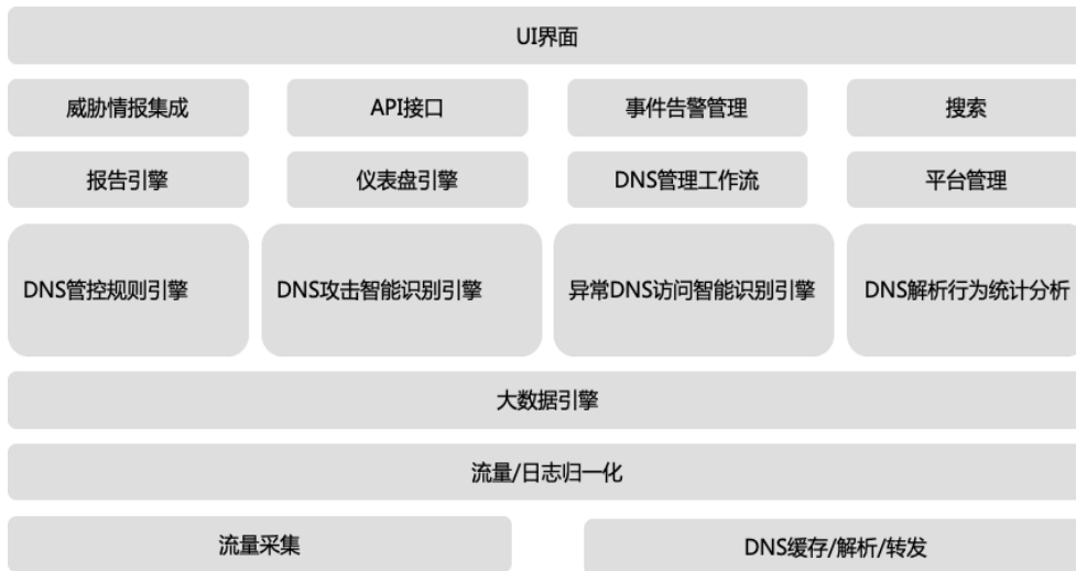
图 4 360DNS 威胁检测防御系统架构
