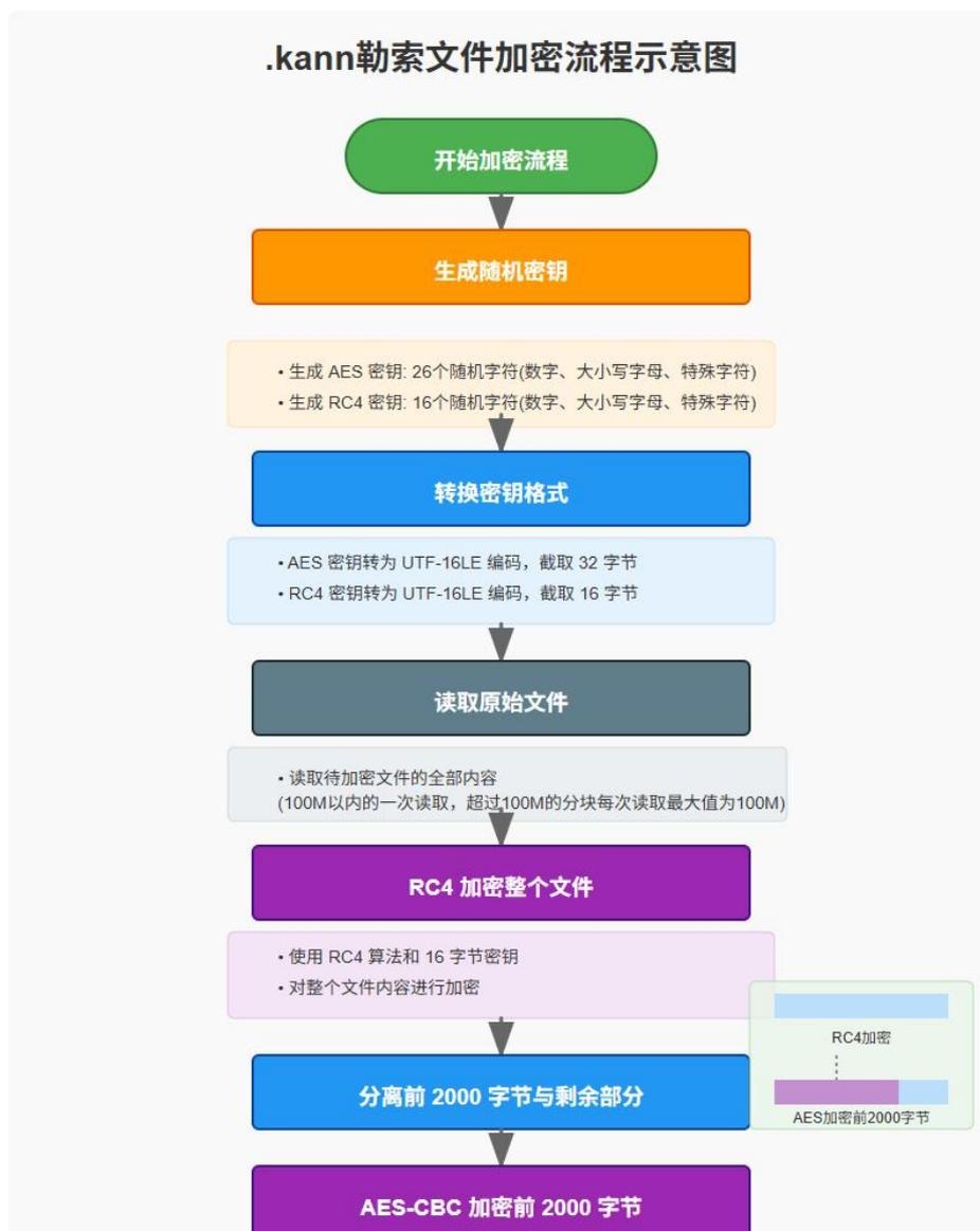
图 1. 加密流程示意图
